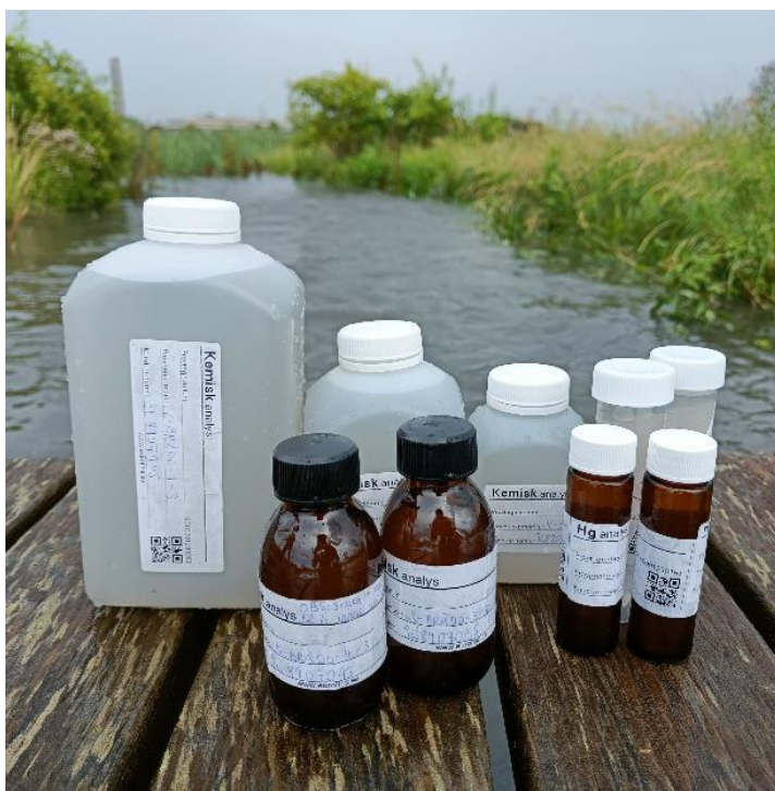
Figur 8. Provtagningsflaskor för en provtagningspunkt som skickades till laboratorium.
