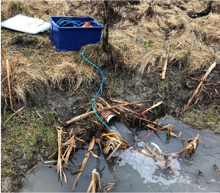
Figur 5. Flödesmätning vid utloppet från Kungsängsdammen.
