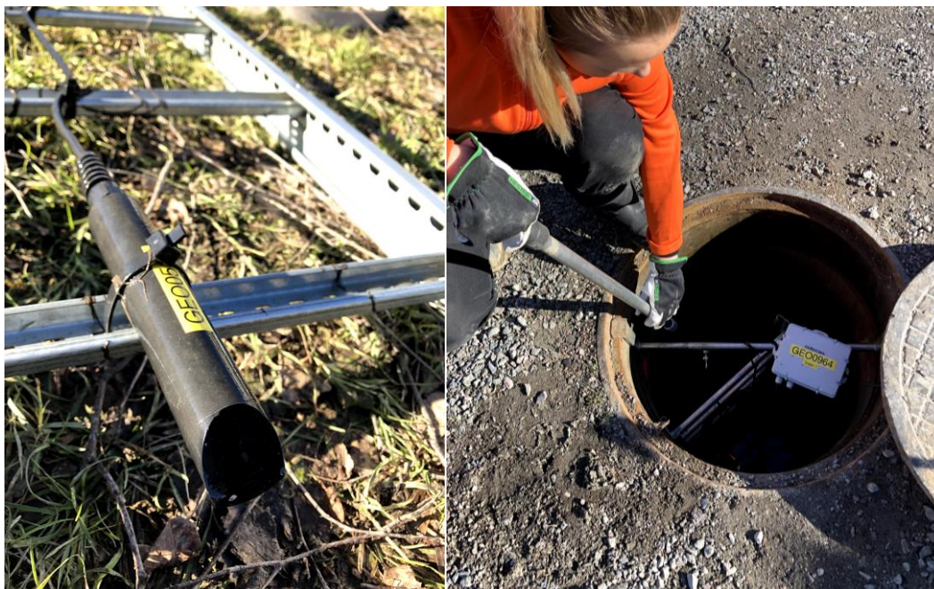
Figur 10. T.v: Turbiditetsgivare som användes för att kontinuerligt mäta turbiditeten vid Librobäck, Luthagen och Svartbäcken. T.h: Exempel på placering av utrustning för kontinuerlig turbiditetsmätning samt stickprovtagning i dagvattenbrunn vid Svartbäcken.
