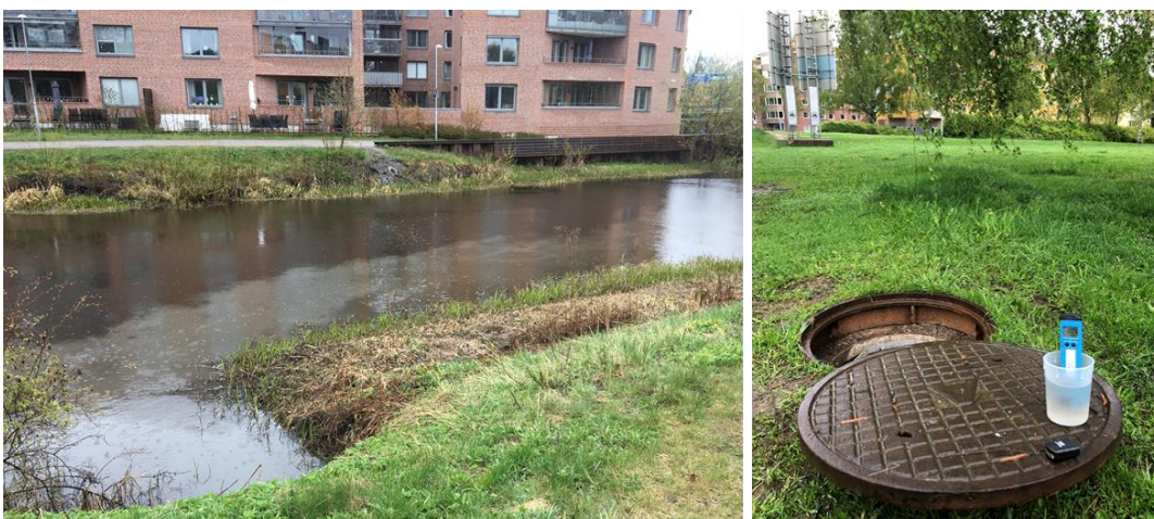
Figur 4. T.v: Luthagens mynning i Fyrisån med en ljusplym av dagvatten i ån. T.h: Dagvattenbrunn strax uppströms ledningens mynning i ån, vattenprovtagning har utförts i brunnen.
