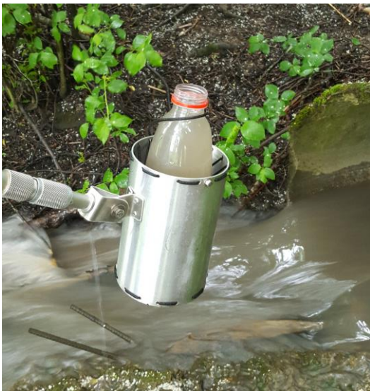
Figur 8. Fyrisåhämtare med provtagningsflaska.
