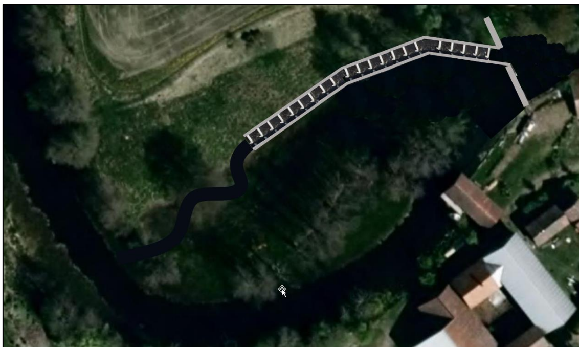
Figur 23. Illustration av den föreslagna slitrännan med en bäckfåra från den övre ingången upp till huvudfåran.
