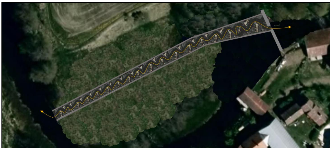
Figur 18. Alternativ 1. Illustration som visa hur ett inlöp längs den norra stranden kan utformas. Källa ortofoto: Eniro.se. Den slutgiltiga utformningen anpassas till områdets förutsättningar.
