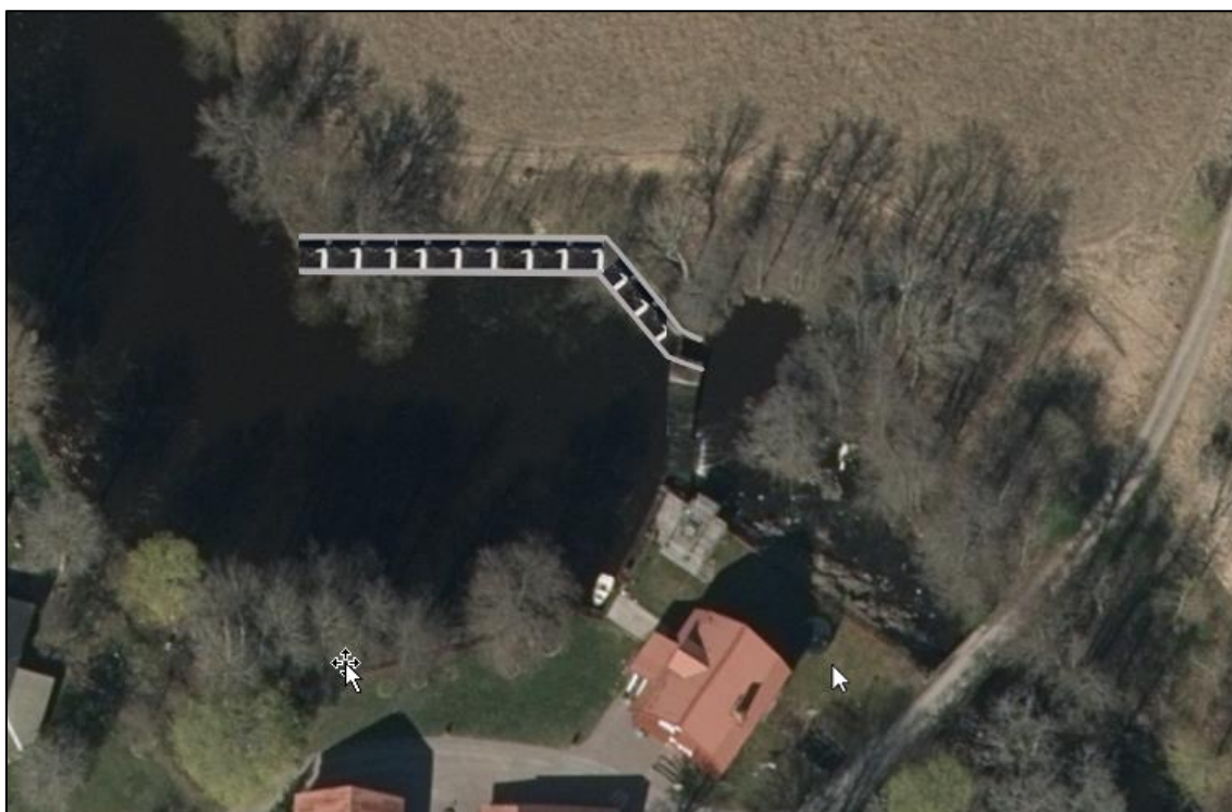
Figur 21. Alternativ 2. Illustration som visar hur en slitsränna längs norra stranden kan utformas. Källa Ortofoto: Eniro.se. Den slutgiltiga utformningen anpassas till områdets förutsättningar.
