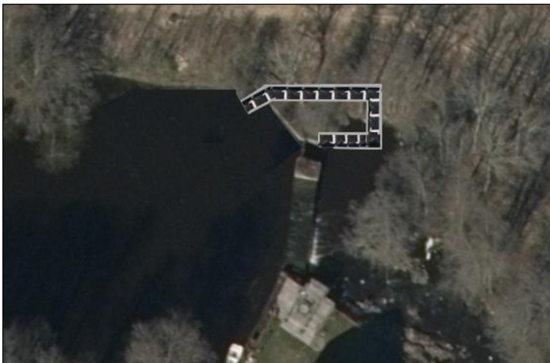
Figur 24. Alternativ 3. Illustration som visar slitsränna öster och runt dammen. Källa Ortofoto: Eniro.se. Den slutgiltiga utformningen anpassas till områdets förutsättningar.
