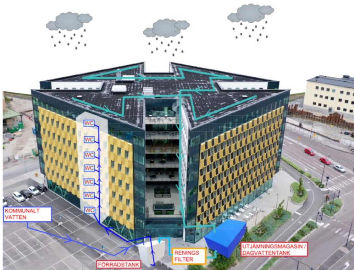
Figur 8. Schematisk illustration av systemet för insamling av regnvatten till toalettspolning i Citypassagen, Örebro. Källa: Castellum
